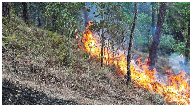
FIGURA 29. Muestra de comportamiento del fuego en quema prescrita experimental en un tramo a favor (simulación de incendio forestal). La baliza mide 2 m de longitud.
